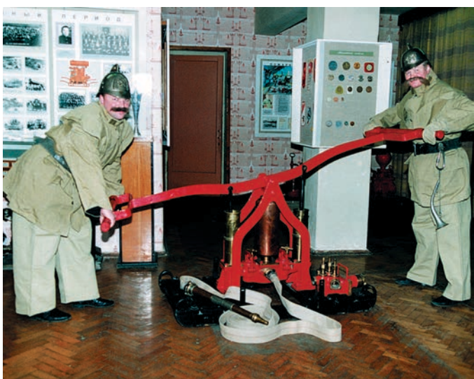
Ручная пожарная труба фирмы «Лангеншипен», начало XX века.
