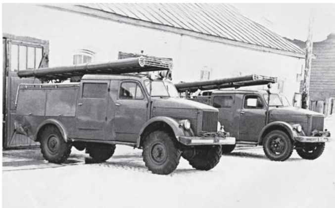
Автоцистерна ПМГ-19 на шасси автомобиля «ГАЗ-63». Пожарная команда Никольска. 1959 год.
