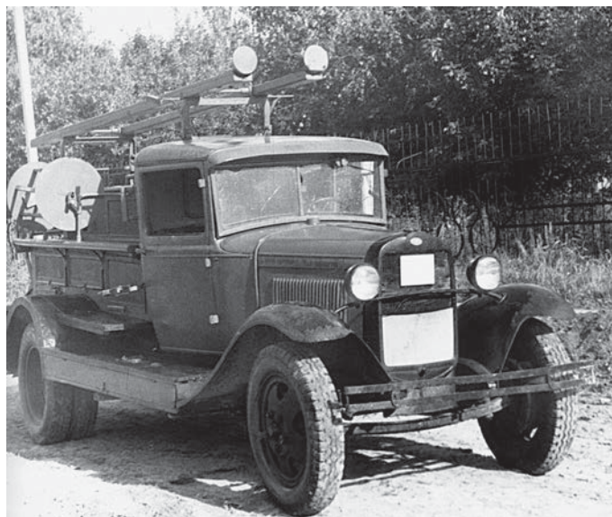
Автонасос ПМГ-1 на шасси ГАЗ-АА.
