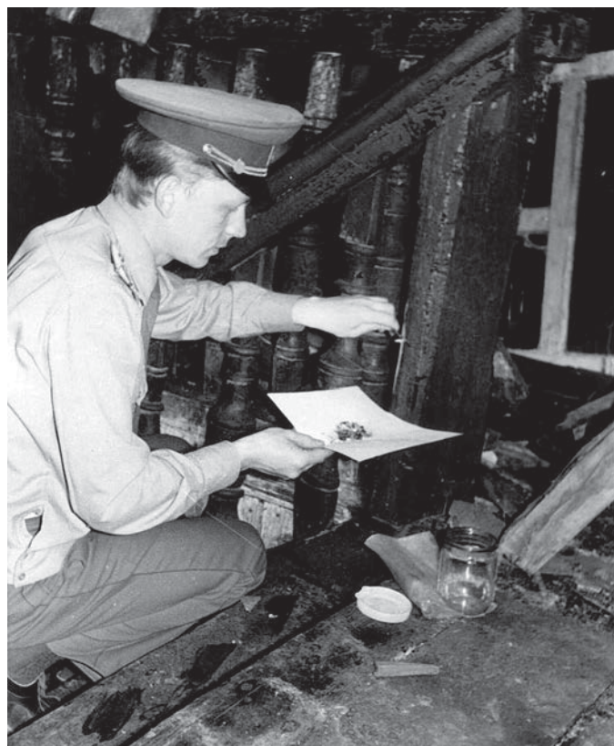
Сотрудник ИПЛ А. Ф. ТИХОМИРОВ проводит изъятие проб древесины на наличие ЛВЖ/ГЖ.
