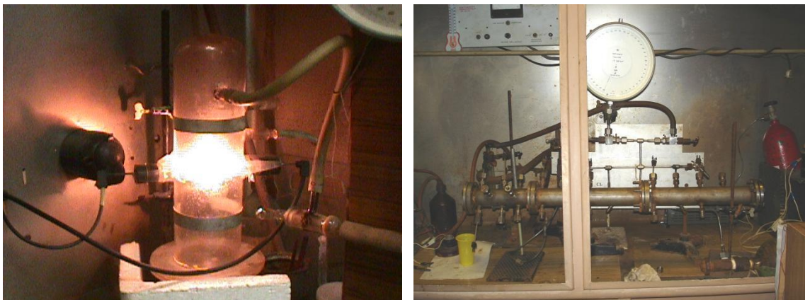
Экспериментальные установки по исследованию пожарной опасности альтернативных хладонов и фотовоспламенения хлорсодержащих горючих смесей
