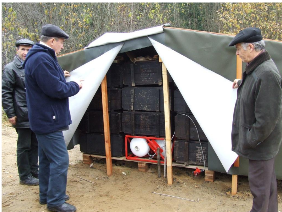
Испытания автоматического устройства предотвращения распространения пламени в штабеле специзделий
