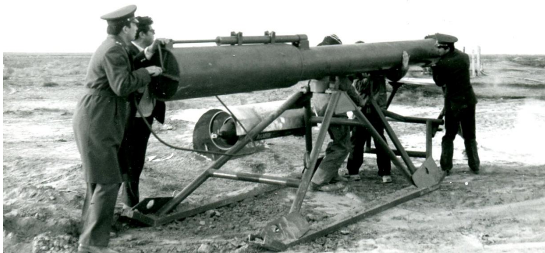
Подготовка импульсного порошкового пламяподавителя (ПП-200) к тушению газового фонтана на месторождении г. Мубарек (Узбекская ССР)
