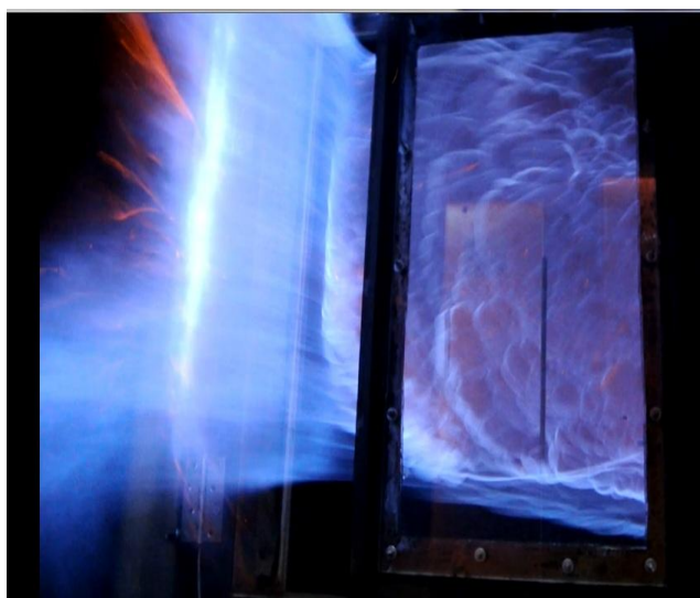
Истечение сгорающих газов через проем взрывной камеры
