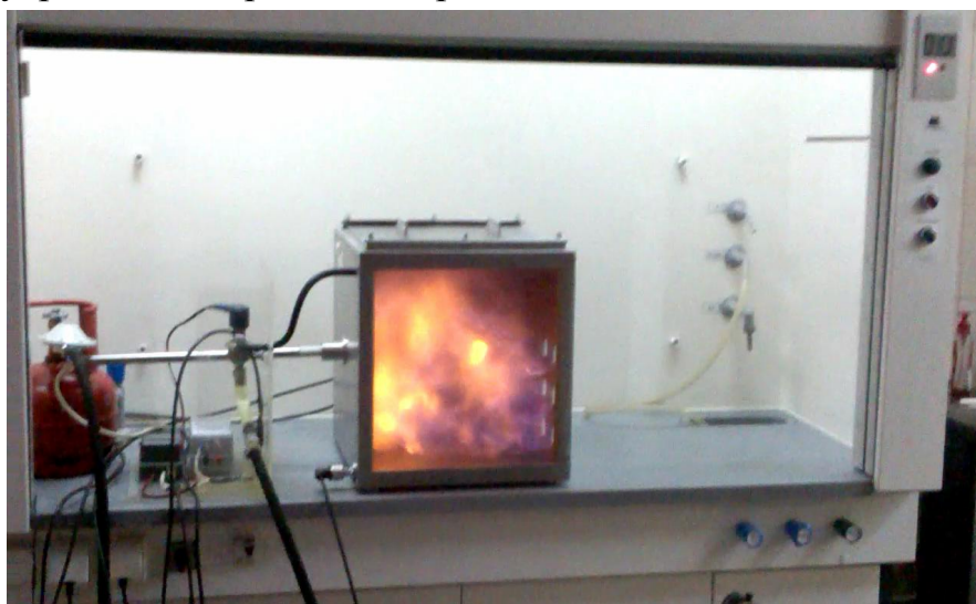
Воспламенение пропан-воздушной смеси в взрывокамере в лаборатории кафедры процессов горения
